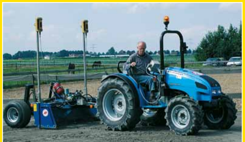
KB-055-180 mit doppelter Lasersteuerung.
