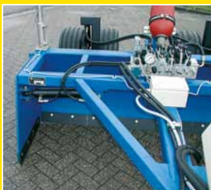
KB-80/200 mit hydraulischen Türen mit auswechselbaren Hardox Messer sowie elektrisch/hydraulisch 100% proportionaler Steuerung.
