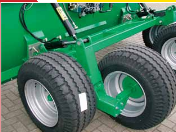
Pendelradgestell mit Rädern ins Gehr.
