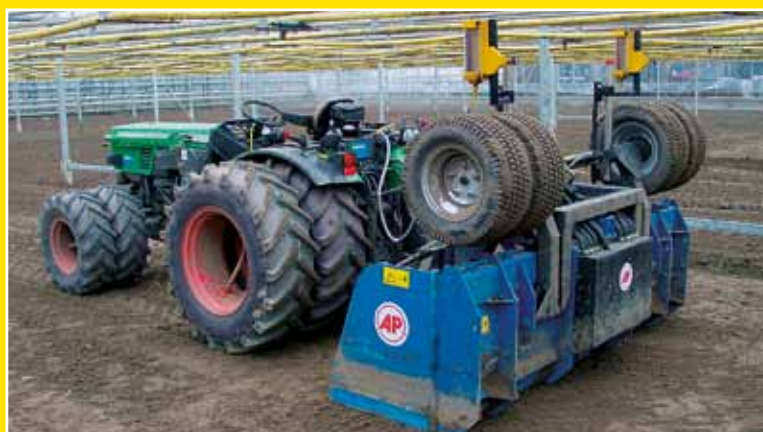
AP Planiermaschine für Treibhäuser mit doppelter Lasersteuerung und aufgeklappten Rädern
