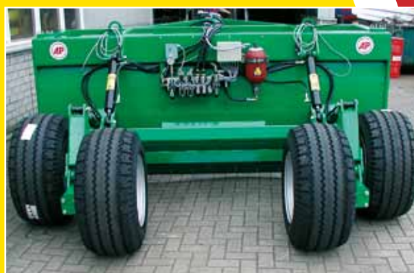
AP Planiermaschine KB 130/300 mit doppelter Neigungsverstellung.
