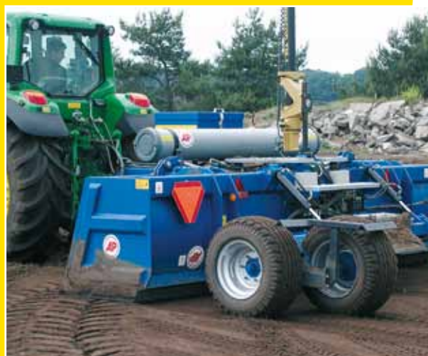
AP ausklappbare Planiermaschine ausgestattet mit dem "AG-System" von Topcon. Dieses Lasersteuerungssystem hat eine sogenannten Einmessungsfunktion. Weil die Planiermaschine über den zu planieren Untergrund fährt (10 cm zu hoch), mißt das System die verschiedenen Höhen. Danach berechnet das System die Durchschnittshöhe und man kann mit der Bodenplanierung beginnen. Ein großer Vorteil ist, daß nie zuviel Erde liegen bleibt und daß man nie zuwenig Erde hat.
