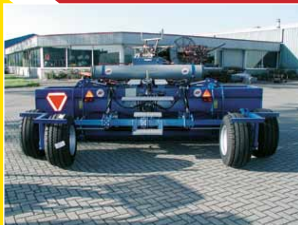
AP ausklappbare Planiermaschine mit völlig ausgezogenem Radgestell, angebauter Platte und Treppe zur Montierung der Maschine-Empfänger, PVC-Rohr zum Transport des Stativs und einer Kiste zur Aufbewahrung der Laserkomponenten. Oben auf den Reifen sind Schmutzabweiser montiert worden. Die Rädern stehen ins Gehr.
